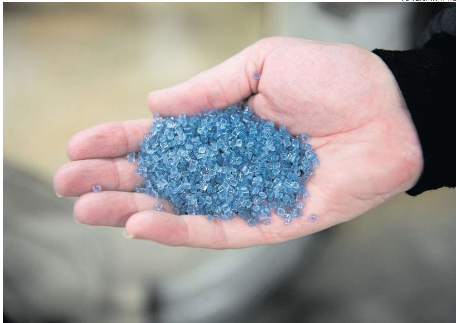
PET – hier in Granulatform – ist der einzige Kunststoff, der auch in rezyklierter Form für Lebensmittel verwendet werden darf.
